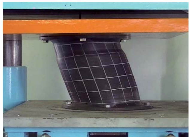
Essai en cisaillement défense CSS avec panneau et plaques frontales en PE-UHMW
