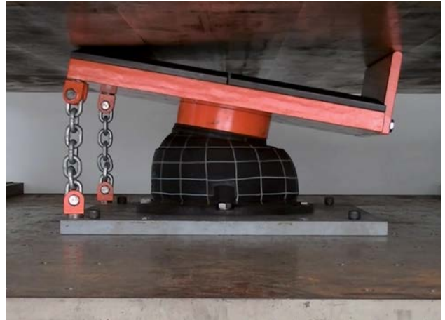
Essai de compression angulaire défense SPC avec chaînes de retenue
