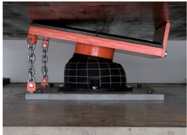
Testowanie ściskania kątownego odbojnicy SPC z łańcuchami mocującymi
