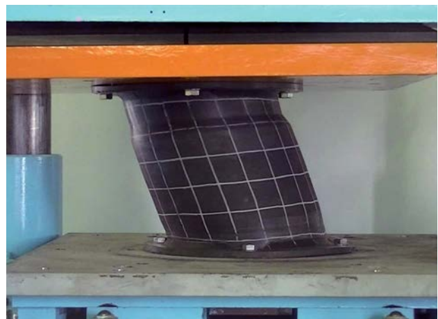
Testowanie na siły ścinające odbojnicy CSS z panelem i płytami czołowymi UHMW-PE
