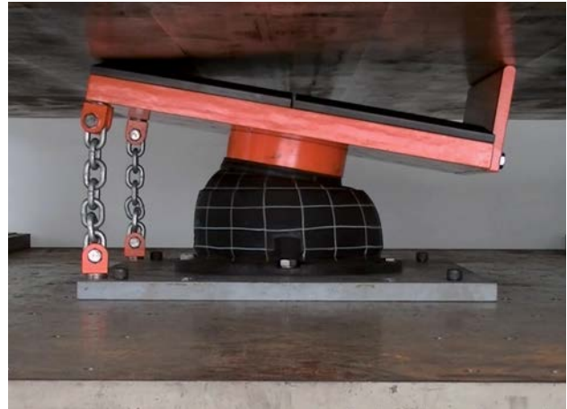
Testowanie ściskania kąowego odbojnicy SPC z łańcuchami mocującymi
