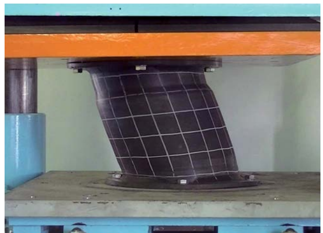
Teste de cisalhamento de Defensas CSS com painel e placas UHMW-PE
