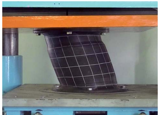
Испытания ОУ CSS на сдвиг при наличии фронтальной рамы и накладок из СВМПЭ
