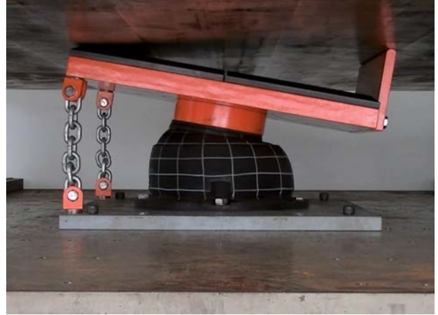
Испытания ОУ SPC со сжатием под углом при наличии ограничивающих цепей
