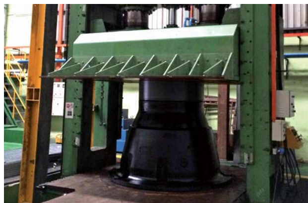
Испытания резинового отбойника
