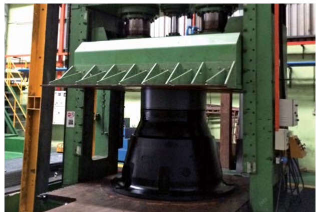
Prueba de defensa de caucho
