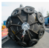
Defensas neumáticas con redes de cadenas y neumáticos Terminal de cruceros Montreal, QC, Canadá (2016)
