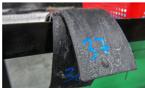
Muestra de ensayo del compuesto final para los ensayos de material
