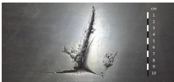
Protuberancia en la defensa (debe repararse o reemplazarse)
