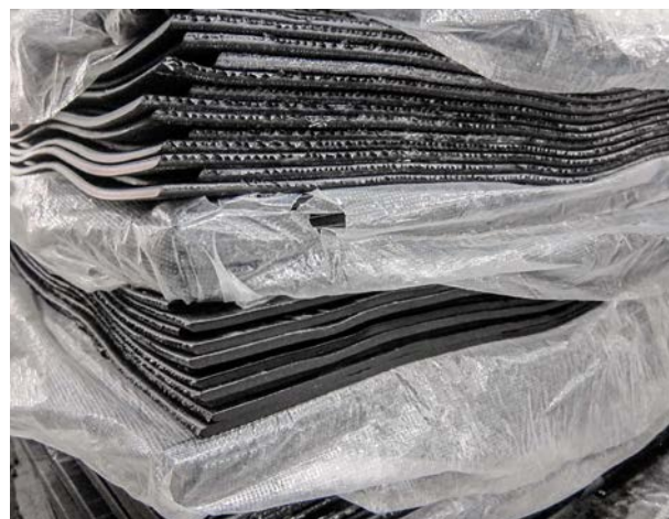
Mélange-maître coupé et empilé pour la finalisation
