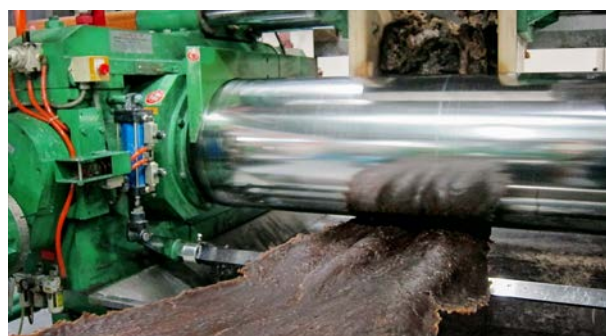
Caoutchouc mastiqué dans un laminoir
