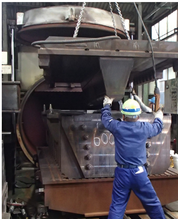
Fermeture d'un moule avec une contrepartie avant le durcissement.
