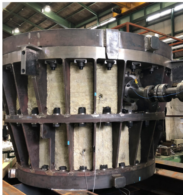
Les moules à enveloppement avec des boulons durant l'injection de caoutchouc à haute pression.
